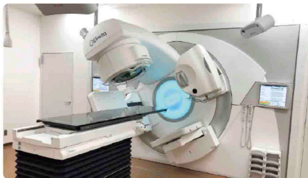
図③ 放射線治療装置 リニアック(Elekta社製 Infinity)
