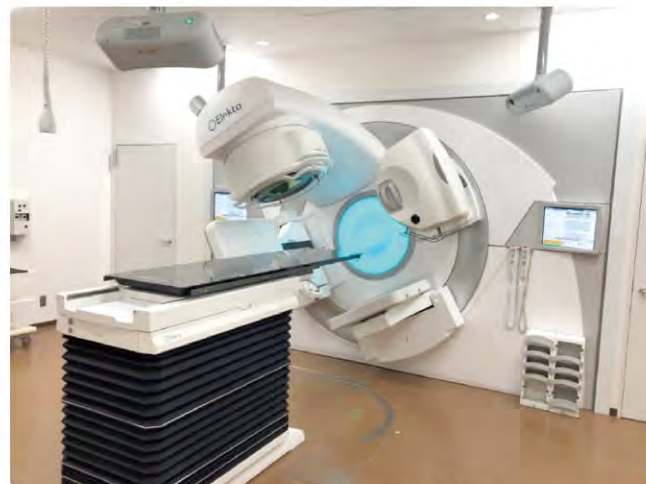
図③ 放射線治療装置 リニアック (Elekta社製 Infinity)
